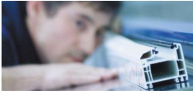
GEALAN extrude des profilés pvc blancs, teintés dans la masse, filmés et acrylcolor permettant la réalisation de fenêtres, selon le cahier des prescriptions techniques du CSTB « Menuiseries en PVC faisant l'objet d'un Avis Technique : conditions générales de mise en œuvre en travaux neufs et sur dormants existants » (E-cahier du CSTB N° 3521).
